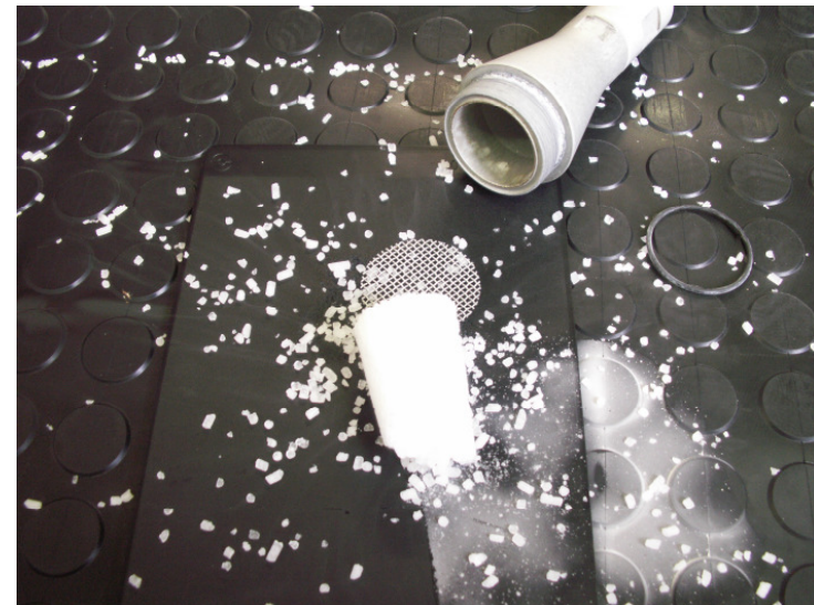
Eisansammlung bei Verstopfung der Strahldüse
