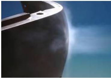
Automatisiertes Vorbehandeln eines Stoßfanges mit CO 2 -Strahlen [1]
