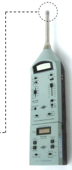
Schallpegelmesser der Fa. B & K vom Typ 2233
