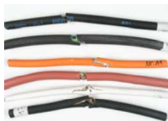
Trockeneisstrahlen von Kabeln Beschädigung durch Kaltversprödung
