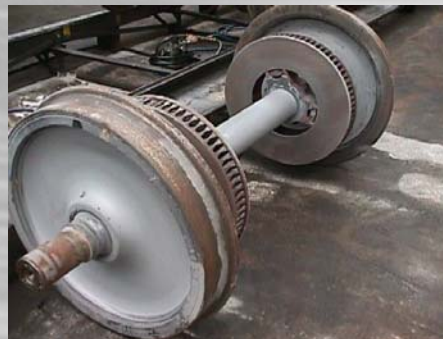
Gereinigter Radsatz mit Radscheiben und Welle
