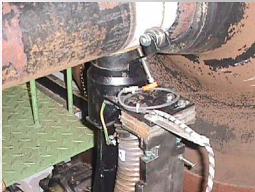
Strahlkopf mit Strahlmittelzufuhr und Saugschlauch an rotierender Radachse
