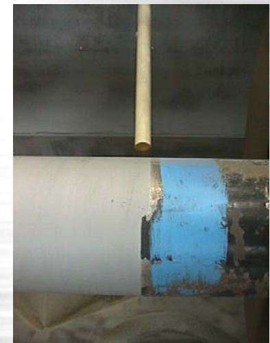
Strahlen der Welle bei drehendem Radsatz
