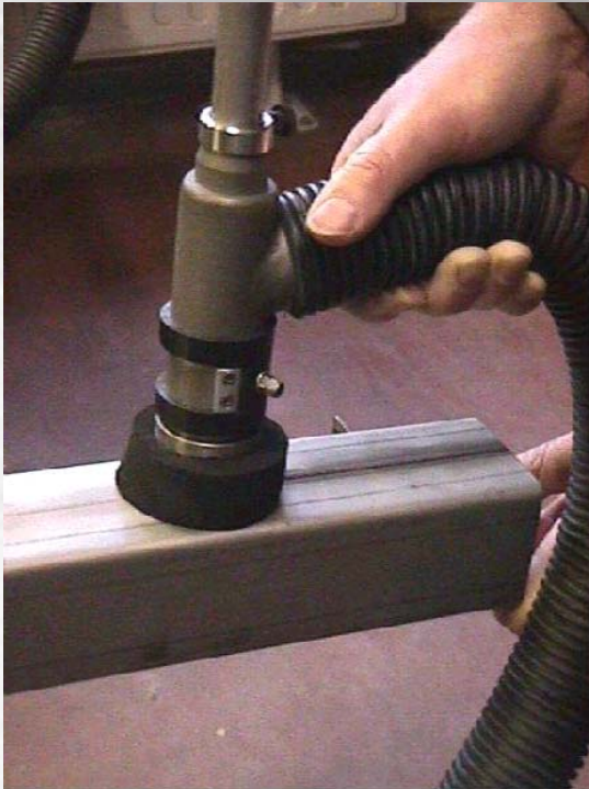
Griffstück mit Flachdichtung
