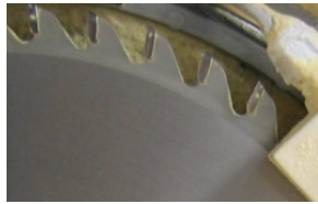
Sägeblatt nach 50 m Vorschubweg und kontinuierlicher Reinigung
