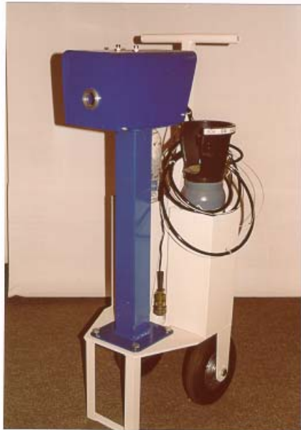
Vorrichtung zum Reinigen von Schweißdüsen an Robotern (Gesamtansicht)
