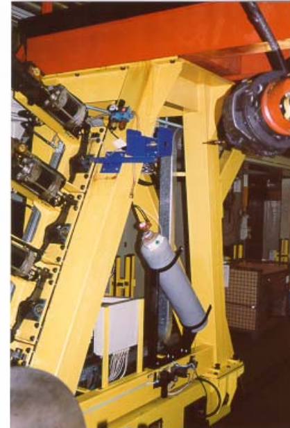
Portal-Schweißanlage umgerüstet zur Reinigung mit BRV-Robo. Vorrichtung ohne Abdeckhaube montiert.
